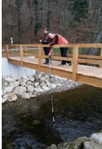
Slika 17: Merjenje hitrosti reke (I. Dular, 2016)
