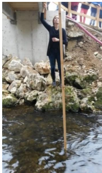
Slika 11: Merjenje prečnega preseka struge 3. 2. 2016 (I. Višček, 2016)
